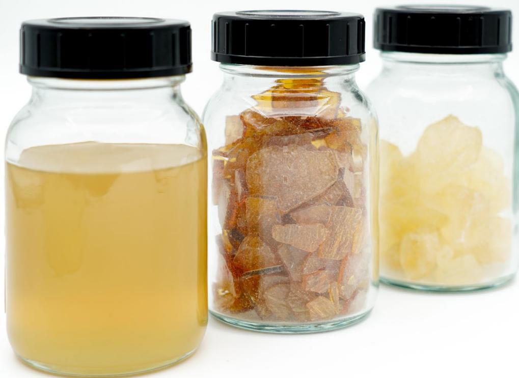
Figura 2 - Adesivo desenvolvido com resina de colofónia modificada para aplicação em calçado.
