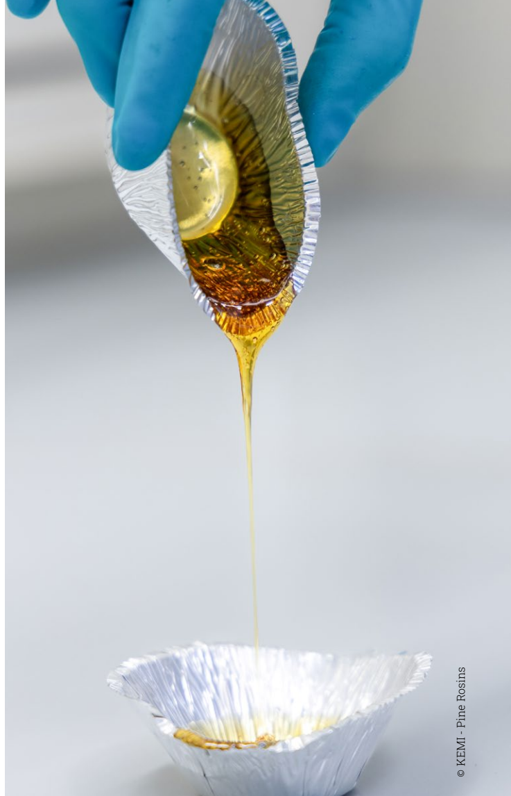
Figura 4 – Poliamida semi-sólida à temperatura ambiente, com ponto de amolecimento de 67°C, sem tackifier.
