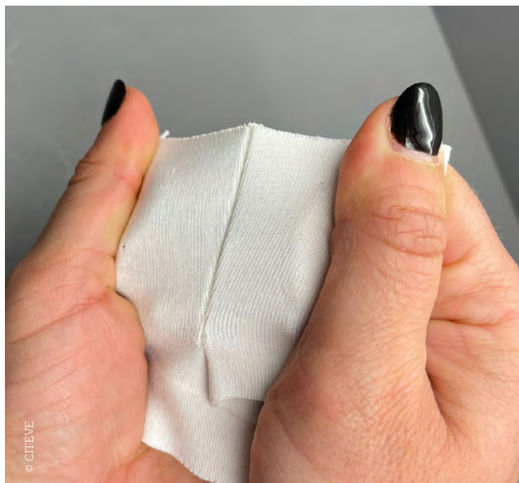
Figura 2. Exemplos de materiais têxteis desenvolvidos no âmbito do Projeto RN21: substratos laminados e revestidos, com derivados de resina de colofónia.
