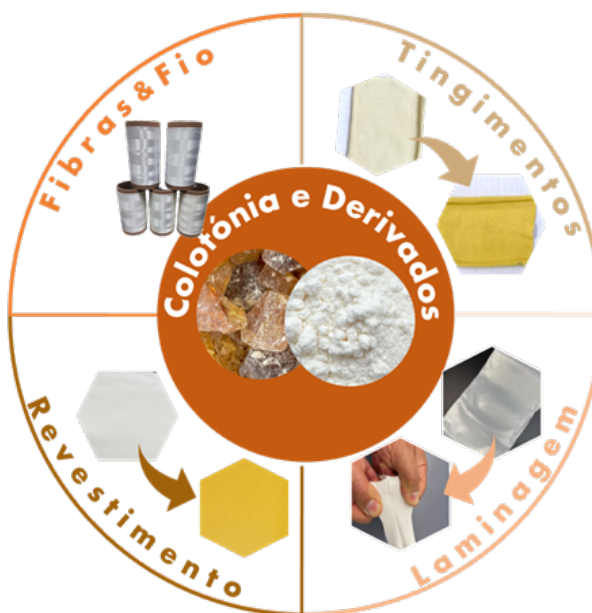
Figura 1. Representação esquemática das diferentes aplicações exploradas para o uso da colofónia e seus derivados na ITV.
